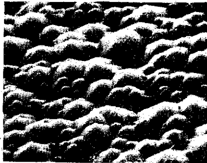
Figura 2. Fotografía obtenida por SEM de la textura de las celdas
