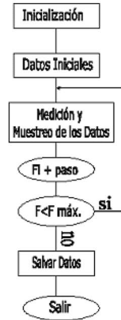
Figura 2.- Algoritmo general del programa. F_i y F_{m\acute{a}x} se refieren a las frecuencias iniciales y finales de la medición, respectivamente.
