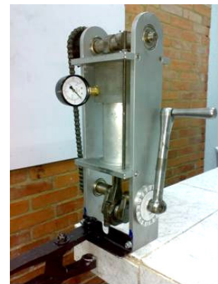
Figura 2. Fotografía del modelo de pistón didáctico con cilindro de aluminio.
