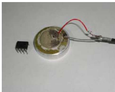
Figura 3. Montaje de la cerámica piezoeléctrica.
