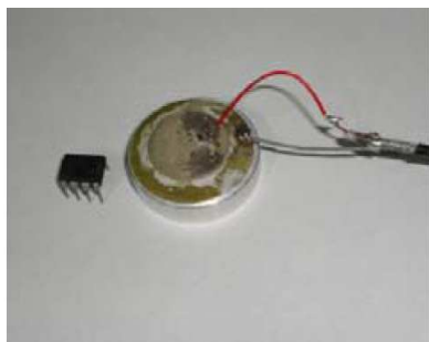
Figura 3. Montaje de la cerámica piezoeléctrica.
