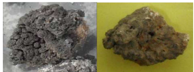
Figura 4. Izquierda: Muestra con mayor presencia de yeso. Derecha: Muestra con mayor presencia de calcita
