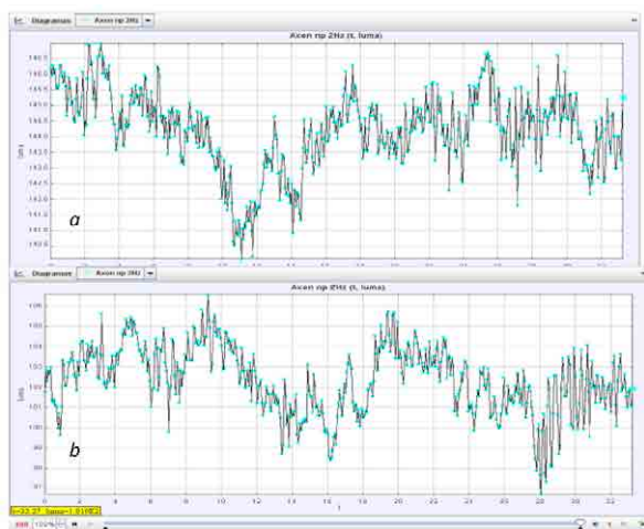
Figura 9: Fluctuaciones temporales de la intensidad en el patrón por transmisión a través de la solución salina (a) y a través de la membrana neurotransmisora (b).
