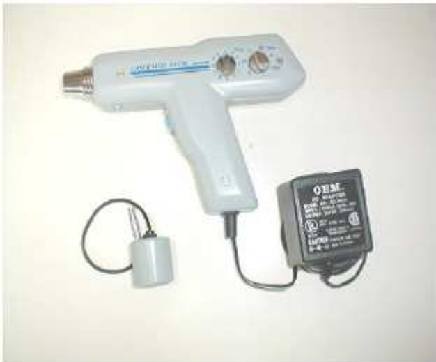
Figura 2. LASERMED 401. Equipo de fisioterapia y acupuntura desarrollado en el CEDEIC que empleaba un diodo láser infrarrojo como fuente luminosa.
