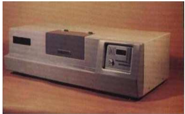
Figura 3. Polarímetro automático y digital LASERPOL 101, introducido en la Planta de Sueros y Hemoderivados de Ciudad de La Habana, para el control de la producción de sueros de glucosa y otros productos, con el mismo se controlaba la producción de estos productos en el país.
