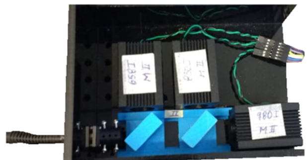
Figura 5. Módulo óptico (uno de seis). En azul se observan los soportes de los espejos dicróicos y en negro los disipadores de los tres láseres.
