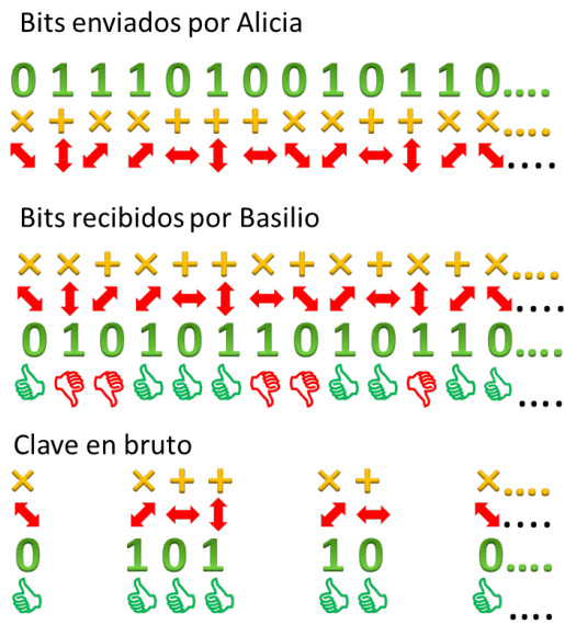
Figura 3. Se representa el proceso de encriptación cuántica según el protocolo BB84. En el panel superior se muestra el primer paso: Alicia envía un grupo de bits codificados en la polarización de los fotones. Ella ha utilizado las bases que se indican en amarillo en la segunda línea y los fotones tienen la dirección de polarización que se indica en rojo en la tercera línea. En el panel central se muestra la recepción de Basilio. También aquí se pueden apreciar en amarillo las bases que utilizó. Los errores y los aciertos están marcados. Por último, luego de intercambiar las bases, eliminan las medidas con diferentes bases y se quedan con lo que se conoce como clave en bruto. Para saber si hubo alguna intrusión, intercambian algunos bits que luego se desecharán. Finalmente, tienen la clave para cifrar los mensajes.
