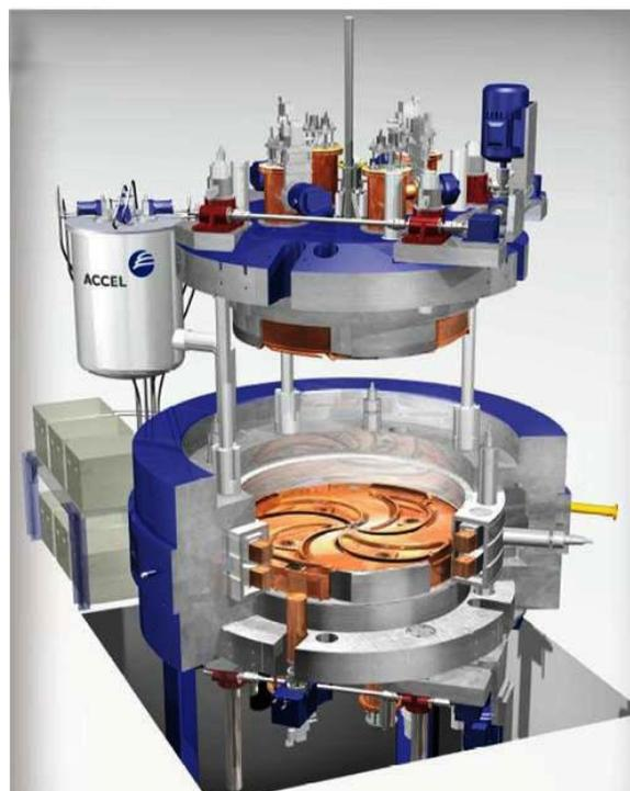
Figura 3. Esquema del ciclotrón superconductor de 90 toneladas y 250 MeV construido por ACCEL Instruments GmbH. El diámetro es de 3.4 m.
